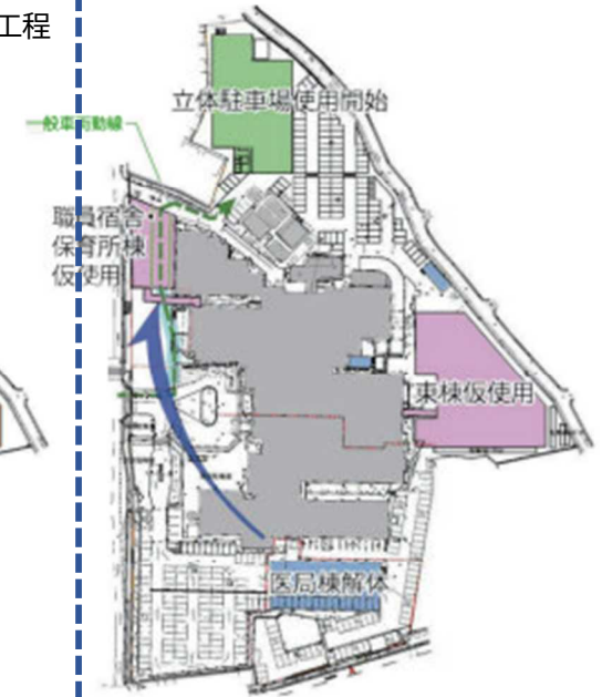
STEP4 東棟、職員宿舎・保育所棟仮供用開始 医局棟解体
