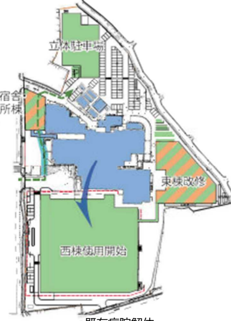
STEP7 既存病院解体 東棟・職員宿舎改修
