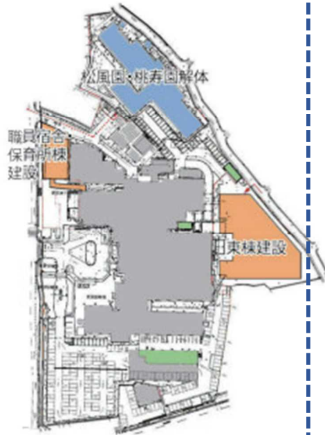
STEP2 職員宿舎・保育所棟建設 松風園・桃寿園解体
